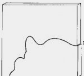
Fig. 2 — Rupture monofilaire. 1. origine de la fracture
